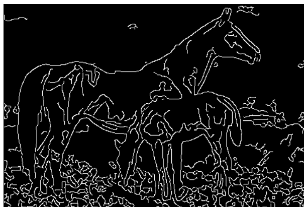
Σχήμα 4: Αποτέλεσμα ανίχνευσης ακμών με τη μέθοδο του Canny.
