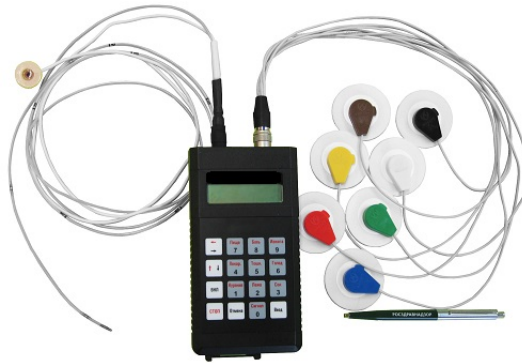
Σχήμα 16.1: Φορητή συσκευή ηλεκτροκαρδιογραφήματος.
