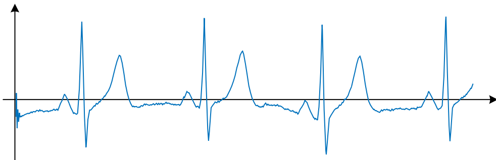
Σχήμα 17.4: Αποτέλεσμα αποθρομβοποίησης ηλεκτροκαρδιογραφήματος με notch φίλτρο.
