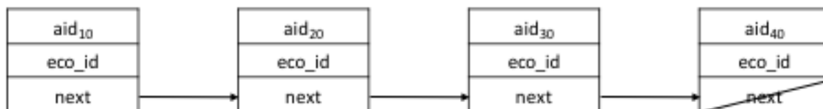
Σχήμα 1: Η απλά συνδεδεμένη λίστα ζώων, η οποία είναι ταξινομημένη σε αύξουσα διάταξη με βάση το αναγνωριστικό του κάθε ζώου.
