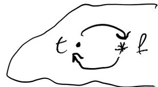
$2 \text{sinc}(3t) \cdot \text{sinc}(2t) \leftrightarrow 2 \text{rect}\left(\frac{f}{3}\right) * \text{rect}\left(\frac{f}{2}\right)$
