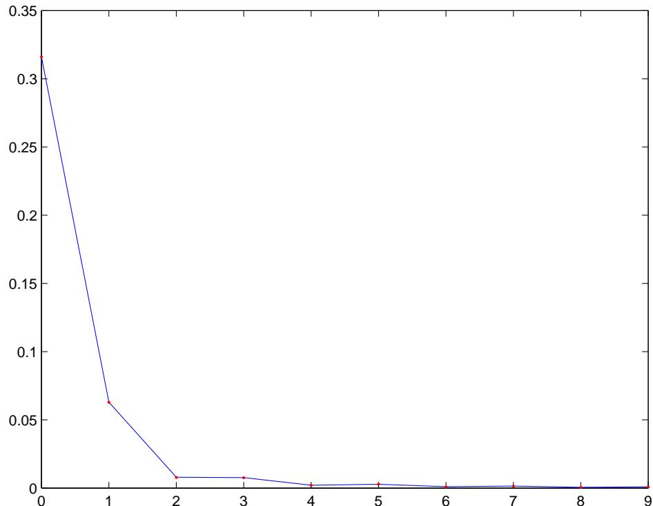
Σχήμα 1: Οι κόκκινες τελείες αντιστοιχούν στις τιμές των 10 πρώτων συντελεστών του αναπτύγματος σε σειρά Fourier όπως υπολογίστηκαν αναλυτικά στην άσκηση 4. Η μπλε γραμμή δείχνει την αντίστοιχη λύση όταν το ολοκλήρωμα υπολογίζεται χρησιμοποιώντας τη Matlab. Οι δύο λύσεις πράγματι συμφωνούν μεταξύ τους.
