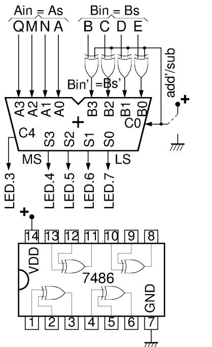
$Cin=1$  και  $Bs'$  είναι η ερμηνεία του Bin' σαν signed. **Στο εργαστήριο**, κατασκευάστε τον προσθαφαιρέτη, και δώστε του τις εισόδους Bin του πίνακα, πρώτα με το σήμα add'/sub στο 0 (πρόσθεση), οπότε πρέπει να βλέπετε τα αποτελέσματα του πειράματος 6.8, και μετά με το σήμα add'/sub = 1 (αφάρεση), ούτως ώστε να διαπιστώσετε πως οι ίδιες πράξεις αυτή τη φορά σαν αφαιρέσεις γίνονται σωστά και δίνουν τα αποτελέσματα του εδώ πίνακα.
