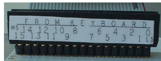
χρησιμοποιήσει είτε σαν μία δεκαεξάμπιτη (16-bit) είσοδο, ή σαν δύο οκτάμπιτες (8-bit) εισόδους, ή σαν τέσσερεις τετράμπιτες (4-bit) εισόδους, ή σαν άλλα μήγματα λέξεων διαφόρων πλατών. Τα 16 bits αριθμώνται από το 0 (λιγότερο σημαντικό - LS) δεξιά μέχρι το 15 (περισσότερο σημαντικό - MS) αριστερά.
