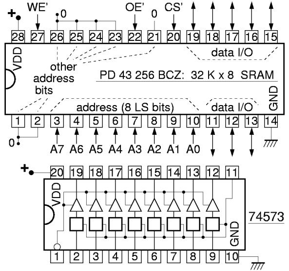
δύο σήματα WE' των δύο chips, και από μάν άλλη, επίσης κοινή είσοδο τα δύο σήματα OE' και των δύο chips. Κάντε το σχεδιάγραμμα του κυκλώματος στην αναφορά του εργαστηρίου σας, και εξηγήστε εν συντομίᾳ το γιατί. Αν έχετε χρόνο, δοκιμάστε το και στο εργαστήριο (π.χ. οδηγήστε τα δύο WE' από τον διακόπτη B', και τα δύο OE' από τον διακόπτη C').
