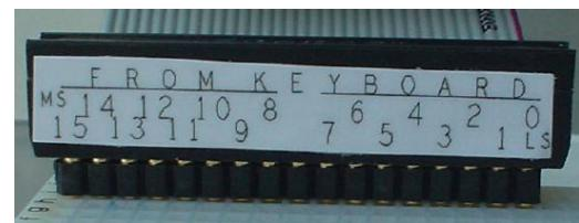
χρησιμοποιήσει είτε σαν μία δεκαεξάμπτη (16-bit) είσοδο, ή σαν δύο οκτάμπτες (8-bit) εισόδους, ή σαν τέσσερες τετράμπτες (4-bit) εισόδους, ή σαν άλλα μίγματα λέξεων διαφόρων πλατών. Τα 16 bits αριθμώνται από το 0 (λιγότερο σημαντικό - LS) δεξιά μέχρι το 15 (περισσότερο σημαντικό - MS) αριστερά.
