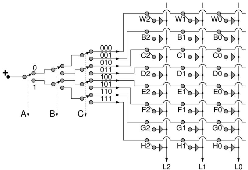
Αυτός ακριβώς είναι ο τρόπος με τον οποίο οργανώνονται οι μνήμες των υπολογιστών και γενικότερα των ψηφιακών συστημάτων, όπως φαίνεται και στο σχήμα. Τα τρία bits επιλογής, A, B, C, αποκωδικοποιούνται στο αριστερό μέρος του κυκλώματος
