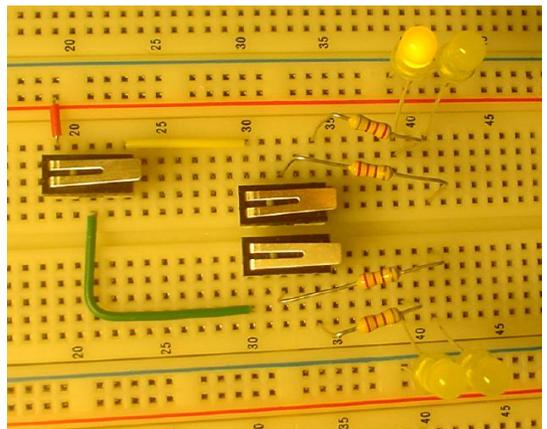
Ο συγκεκριμένος αποκωδικοποιητής εδώ είναι μεγέθους **2-σε-4**, δηλαδή αποκωδικοποιεί 2 εισόδους στους 4 συνδυασμούς τους, άρα έχει 4 εξόδους· το κύκλωμα εδώ έχει σαν εξόδους 4 LED's. Εάν πάνω από κάθε LED βάλουμε ένα ημδιαφανές πλαστικό με γραμμένο επάνω το αντίστοιχο μήνυμα, όπως στο σχήμα δεξιά, θα έχουμε προσφέρει την επιθυμητή βοήθεια στο μάγειρα του ξενοδοχείου.
