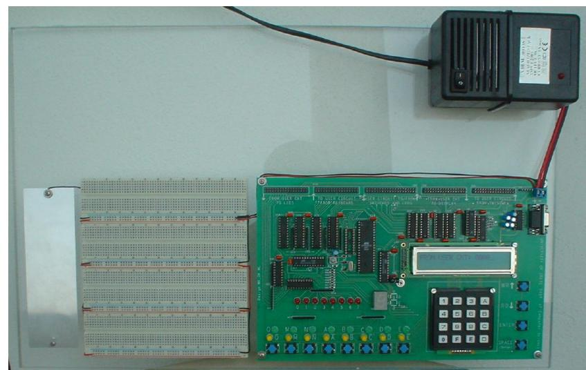
κυκλώματα (chips) τύπου CMOS που είναι ευαίσθητα στον στατικό ηλεκτροισμό. Αμέσως δεξιά από τη γειωμένη πλακέτα υπάρχει η **πλακέτα γενικών συνδέσεων ("breadboard")**, μία άσπρη τρυπητή πλαστική βάση, την οποία θα χρησιμοποιήσετε σήμερα και την οποία περιγράφουμε παρακάτω στην § 0.2.
