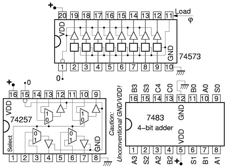
εκείνου του πειράματος 6.8: για διευκόλυνσή σας, τα pins του αθροιστή δίδονται ξανά στο σχήμα εδώ. **Προσοχή:** το chip αυτό έχει τα pins τροφοδοσίας σε ασυνήθιστες θέσεις!
