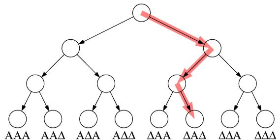
Το κύκλωμα εδώ χρησιμοποιεί τρεις διακόπτες, A, B, και C. Ο διακόπτης A είναι απλός, όπως και αυτοί που έχουμε χρησιμοποιήσει μέχρι τώρα σε προηγούμενα εργαστήρια. Ας συμβολίζουμε με 0 (μηδέν) όταν αυτός είναι επάνω (ελεύθερος) και με 1 (ένα) όταν αυτός είναι κάτω. Ο διακόπτης B είναι *διπλός*, αποτελούμενος από δύο *συνδεδεμένους* απλούς διακόπτες: ο διακόπτης στο κάτω
