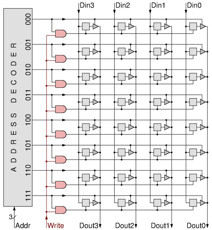
Στο αριστερό μέρος του σχήματος υπάρχει ο Αποκωδικοποιητής Διευθύνσεων (Address Decoder). Προφανώς, τα χιλιάδες (ή εκατομμύρια) (οριζόντια) σύρματα
