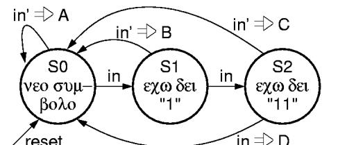
ρολοϊ ck που σημαδεύει, με την ενεργή ακμή του, το τέλος του κάθε bit εισόδου  $in$ . Η FSM έχει 4 εξόδους, A, B, C, D: κάθε μιά τους ανάβει όποτε παραλαμβάνουμε ένα αντίστοιχο σύμβολο, για διάρκεια ακριβώς ενός κύκλου ρολογιού, και συγκεκριμένα κατά τον κύκλο ρολογιού παραλαβής του τελευταίου bit του αντίστοιχου συμβόλου.
