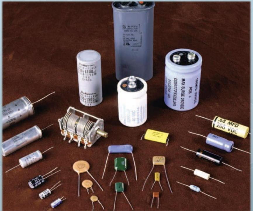
Εικόνα: Όλες οι παραπάνω συσκευές είναι πυκνωτές, οι οποίοι αποθηκεύουν ηλεκτρικό φορτίο και ενέργεια. Ο πυκνωτής είναι ένα είδος κυκλώματος που μπορούμε να συνδυάσουμε με άλλα για να φτιάξουμε ηλεκτρικά κυκλώματα.
