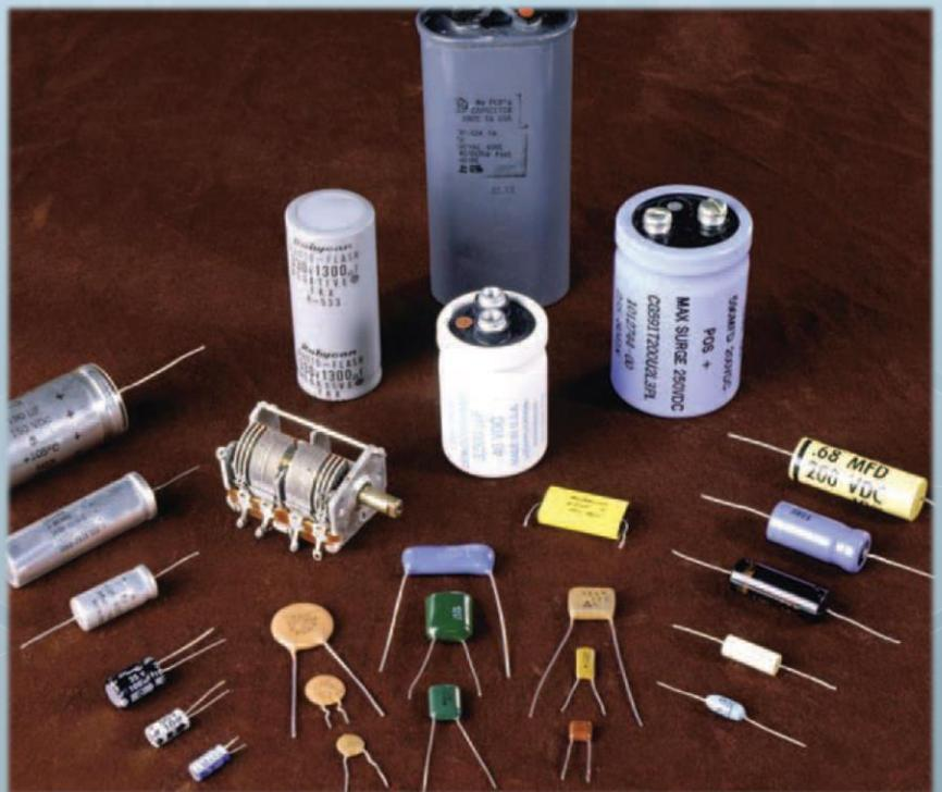
Εικόνα: Όλες οι παραπάνω συσκευές είναι πυκνωτές, οι οποίοι αποθηκεύουν ηλεκτρικό φορτίο και ενέργεια. Ο πυκνωτής είναι ένα είδος κυκλώματος που μπορούμε να συνδυάσουμε με άλλα για να φτιάξουμε ηλεκτρικά κυκλώματα.
