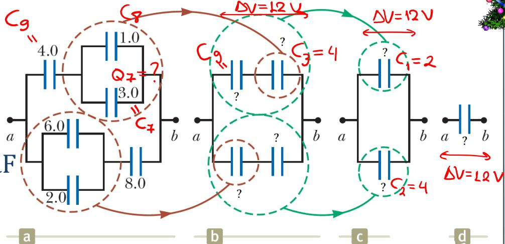
$$\text{Άρα } \Delta V_{C_7} = \Delta V_{C_3} = 6 V.$$
