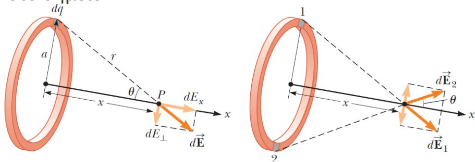
$$E_p = E_x^p = \int dE_x^p = \int k_e \frac{dq \cdot x}{(a^2+x^2)^{\frac{3}{2}}} \cdot \text{[a]} \quad \text{[b]} \quad \text{Τα } x, k_e, a \text{ είναι σταθερές!}$$
