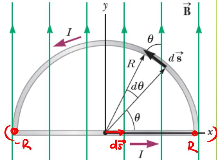
$$\text{Γνωρίζαμε ότι } d\vec{F}_{B_1} = I \cdot d\vec{s} \times \vec{B} \Rightarrow dF_{B_1} = I \cdot ds \cdot B \cdot \sin\left(\frac{\pi}{2}\right) = I \cdot ds \cdot B \\ = I \cdot dx \cdot B \quad ①$$
