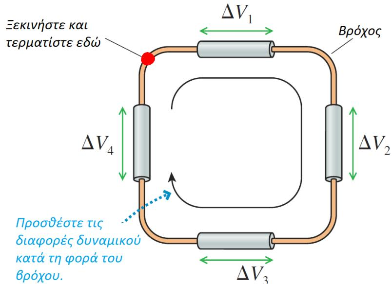
$$\text{Κανόνας βρόχου: } \Delta V_1 + \Delta V_2 + \Delta V_3 + \Delta V_4 = 0$$
