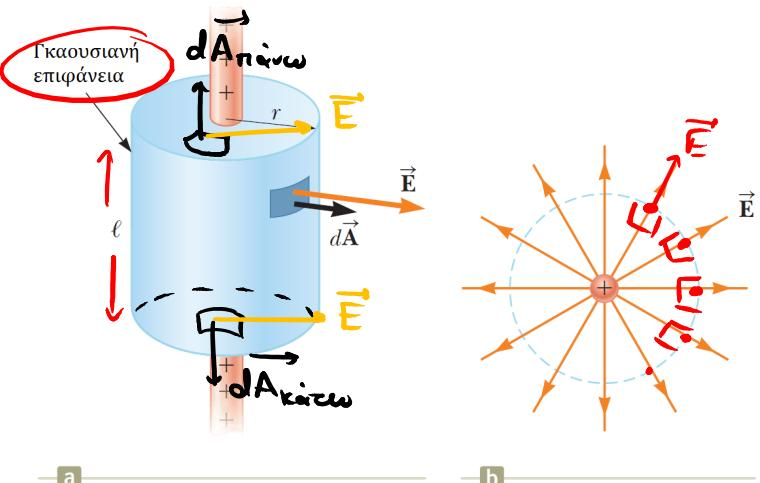
Επιλέγομε κυλινδρική επιφάνεια γύρω από τη ράβδο. Μπορεί να δείξει κανείς σε λίγων των απώταρων γραμμών ότι το ηλεκτρικό πεδίο  $\vec{E}$  είναι σταθερό σε ένα σημείο απόστασης  $r$  από αυτήν. Άρα ικανοποιείται η συνθήκη (1).
