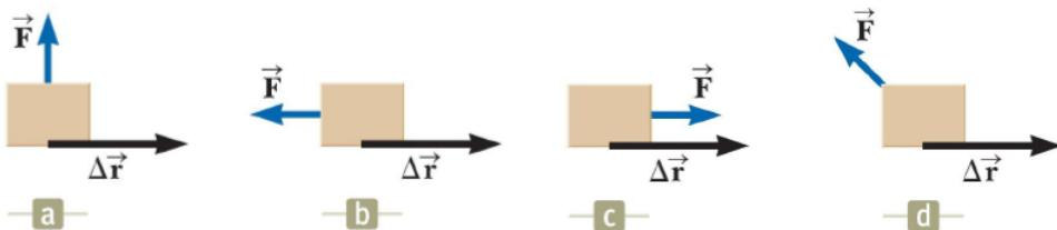
Σχήμα 2.44: Παράδειγμα περιπτώσεων έργου.
