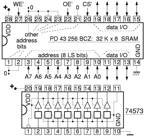
δύο σήματα WE' των δύο chips, και από μιάν άλλη, επίσης κοινή είσοδο τα δύο σήματα OE' και των δύο chips. Κάντε το σχεδιάγραμμα του κυκλώματος στην αναφορά του εργαστηρίου σας, και εξηγήστε εν συντομίᾳ το γιατί. Αν έχετε χρόνο, δοκιμάστε το και στο εργαστήριο (π.χ. οδηγήστε τα δύο WE' από τον διακόπτη B', και τα δύο OE' από τον διακόπτη C').
