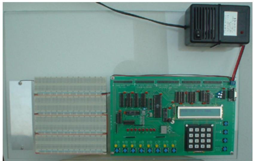
κυκλώματα (chips) τύπου CMOS που είναι ευαίσθητα στον στατικό ηλεκτρισμό. Αμέσως δεξιά από τη γειωμένη πλακέτα υπάρχει η **πλακέτα γενικών συνδέσεων** ("breadboard"), μία άσπρη τρυπητή πλαστική βάση, την οποία θα χρησιμοποιήσετε σήμερα και την οποία περιγράφουμε παρακάτω στην § 0.2.
